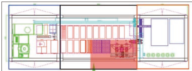
図5 物理的および化学的安定性試験のための自動化システム このシステムは、制御された条件(温度、湿度)下で1,000個までの試験検体を保管するラック一式(中央)、非破壊分析を行う物理分析装置(カメラ、近赤外線&ラマン分光装置(左側))および自動検体調製装置(赤く色づけされた部分)に続く化学分析装置(UPLC/MS(右側))によって構成されている。
