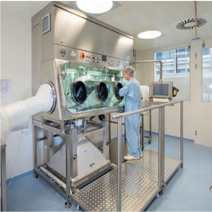
Abbildung 4: Moderne Medikamente sind meist schon in sehr geringen Dosen wirksam und bieten dem Patienten so den grösstmöglichen Nutzen. Bei der Herstellung dieser hochwirksamen Medikamente ist es unerlässlich, die Mitarbeitenden vor dem direkten Kontakt zu schützen weshalb in geschlossenen Anlagen gearbeitet wird. Die Einwaage der Rohstoffe erfolgt hier im Isolator (Foto Roche) (3).
